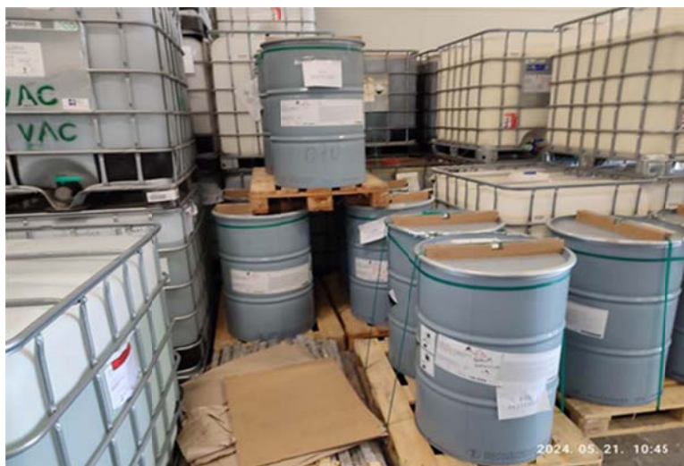
Szabálytalan, a tároló tartály leesésének veszélyével járó anyagtárolás.
