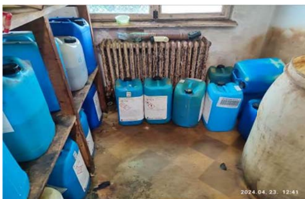
Fémmegmunkálás, veszélyes anyag nem megfelelő tárolása, kármentő hiánya.
