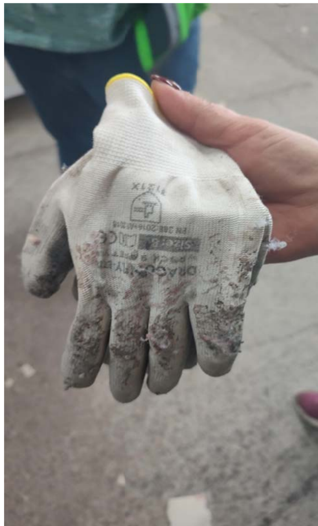
Szivacsragasztáshoz használt, nem a biztonsági adatlapnak megfelelő – vegyi anyagnak nem ellenálló – védelmi képességgel rendelkező védőkesztyű.
