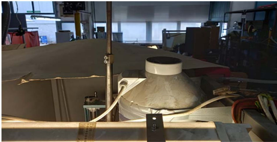
A hegesztő gép elszívó ventilátorának kivezetése a munkakörnyezetbe szállítja a hegesztéskor keletkező füstgázt.
